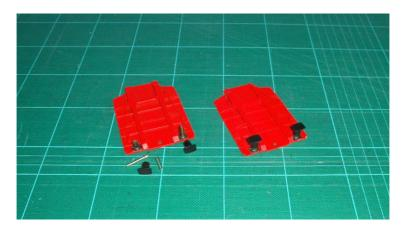
Die bestückten Stirnwände werden auf das Gehäuse geklebt.
