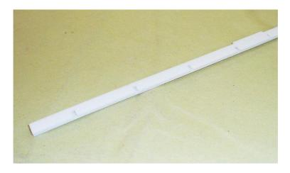
Diese Längsträger werden in die Aussparungen von der Bodenplatte eingeklebt.
