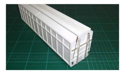
Als alle Messingteile montiert sein kann das Gehäuse und das Rahmen grundiert werden.
